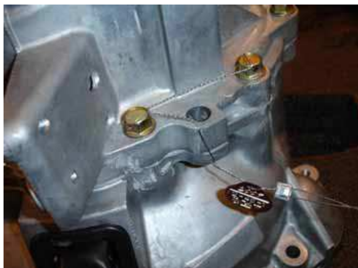
Σφράγιση κιβωτίου ταχυτήτων
